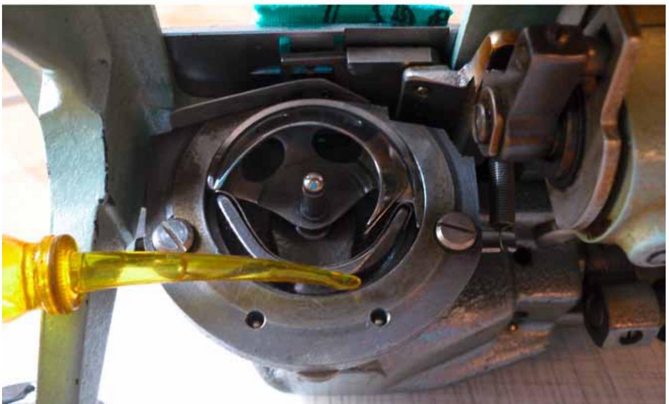
**Spulenkapsel an der Klappe anfassen und in den Greifer einsetzen!**
