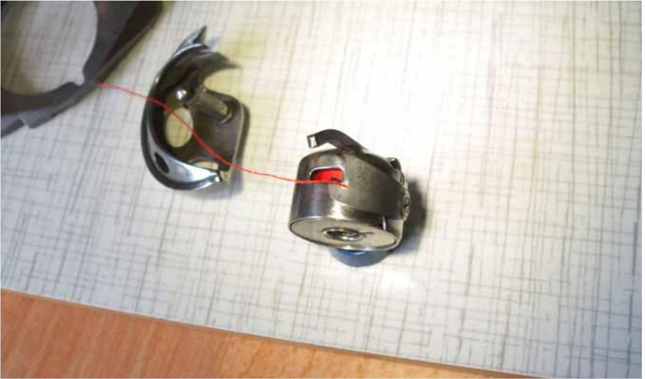
**Zwecks Einstellung der Fadenspannung an der Kapsel wird der Greifer als zusätzliches Gewicht angehängt.**
