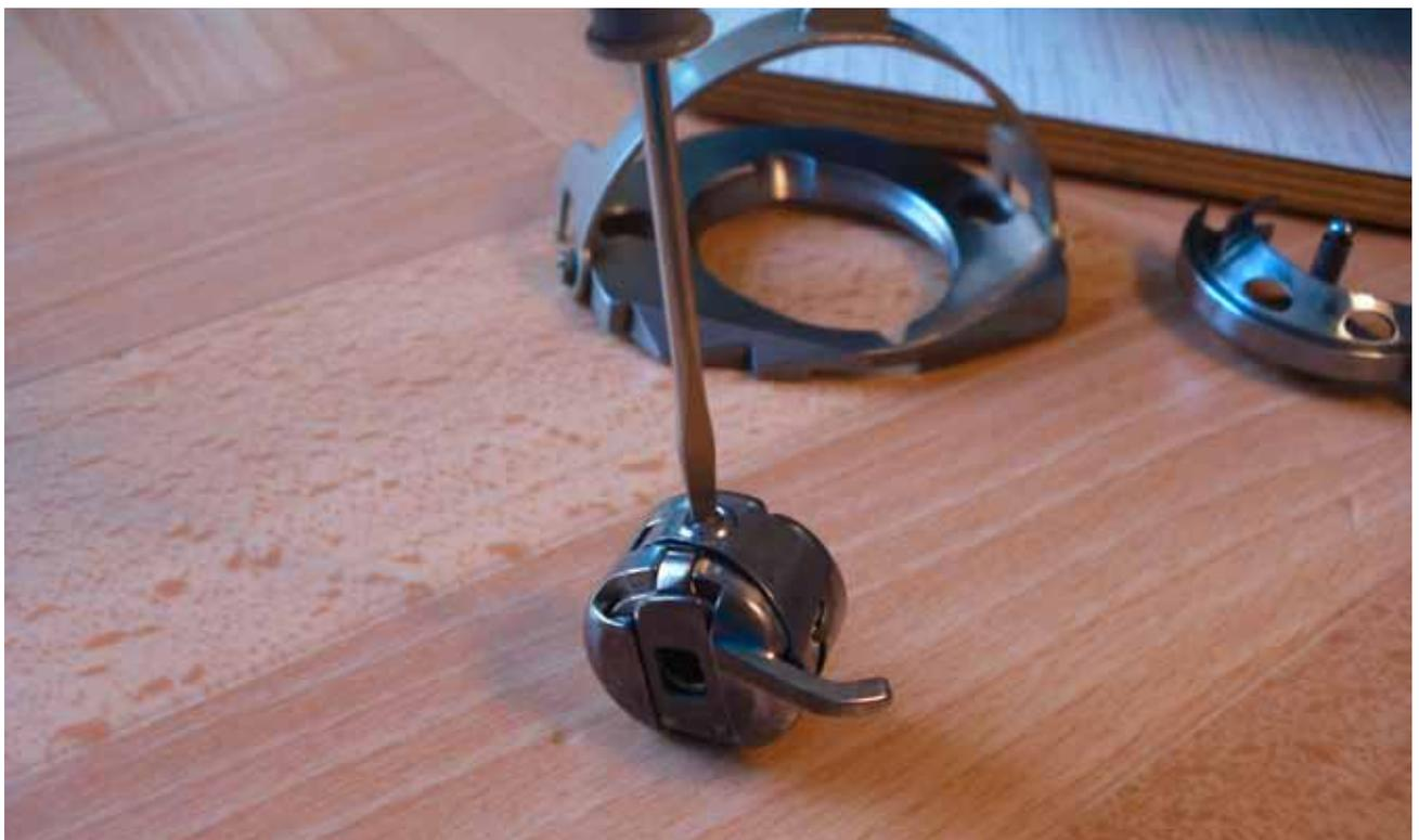
**Zur Entfernung der Klappe muss die innere Schraube gelöst werden.**
