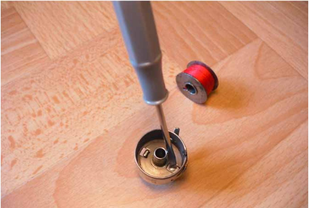
**Klappe nach rechts ziehen und aufklappen, sie lässt sich nun nach links entnehmen.**
