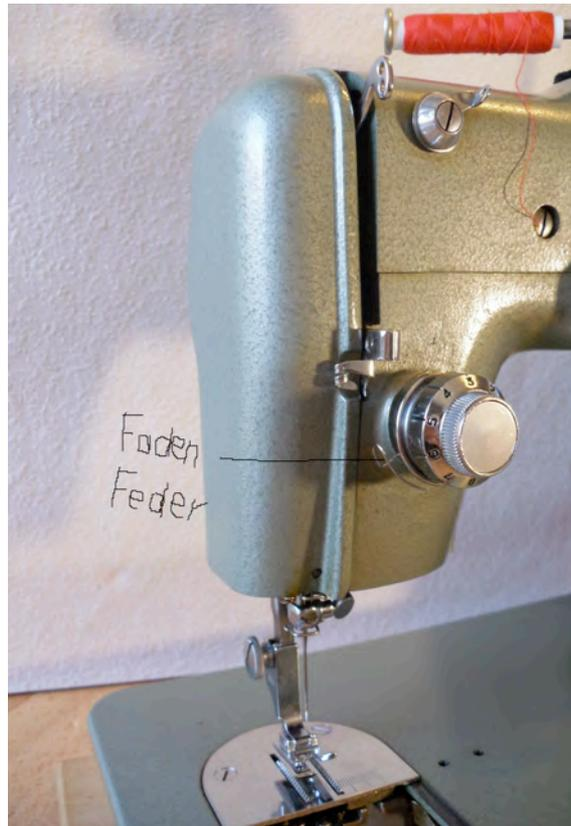
16. Foto: Sie sehen hier, wie der Faden eingerastet ist und von der Fadenfeder straff gehalten wird!
