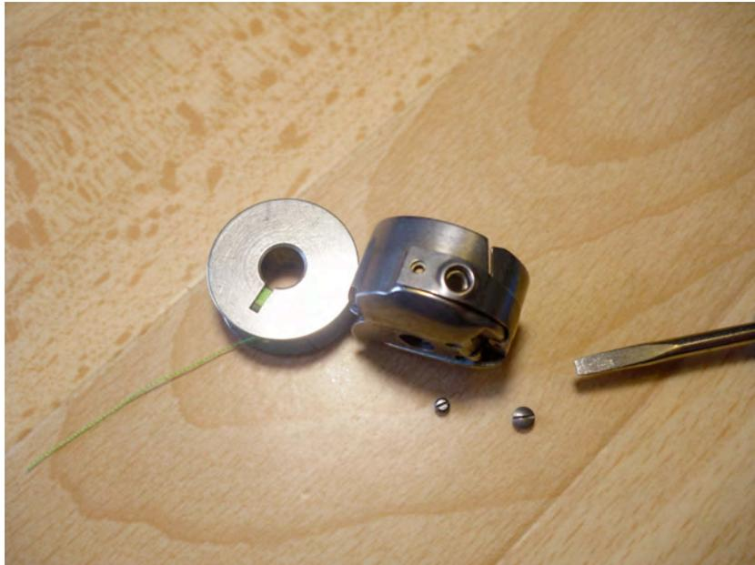
8. Foto: Die Kapselfeder ist nun auch angeschraubt, so dass wir die Spule einsetzen können. Wir legen die Spule mit dem Faden im Uhrzeigersinn in die Kapsel ein und führen den Faden links unter der Feder durch! Ich verwende normales Nähmaschinen-Garn aus Polyester, wie man es beim Discounter preiswert kaufen kann.
