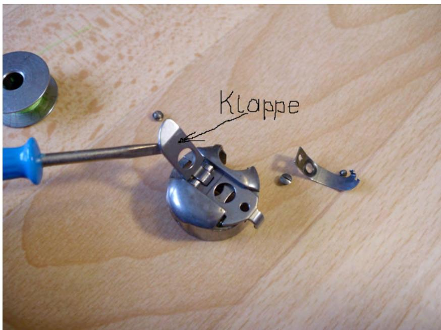
5. Foto: Die gereinigten Teile der Spulenkapsel.
