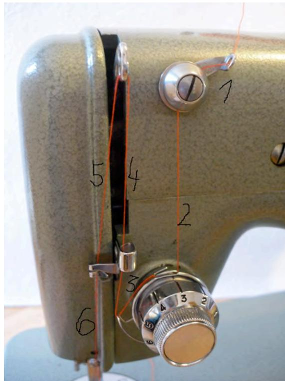
18. Foto: Sie sehen hier die eingefädelte Nadel. Ich bin bereits dabei den Unterfaden hochzuholen, indem ich den Oberfaden festhalte und mit dem Handrad die Nadel nach unten bewege. Der Greifer holt sich hinter der Nadel den Oberfaden und umschlingt damit den Unterfaden. Man kann dann mit dem Oberfaden den Unterfaden hochziehen .
