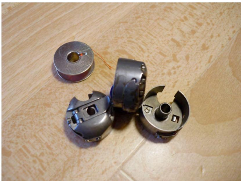
3. Foto: Weil die Spulenkapsel nicht neu ist, schraube ich sie auseinander und reinige sie mit Öl, denn unter der Feder kann sich Schmutz angesammelt haben. Ich löse auch die Schraube im Innern der Kapsel, damit ich auch die Klappe herausnehmen kann.
