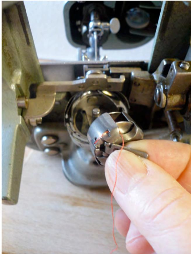
14. Foto: Sie sehen die eingesetzte Spulenkapsel im Greifer. Der Unterfaden muss im nächsten Schritt hochgeholt werden.
