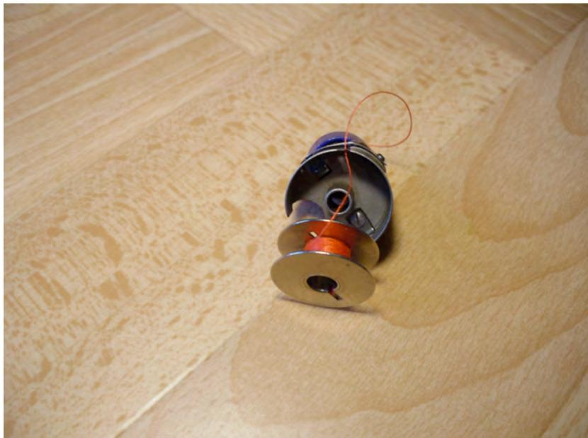
9. Foto: Sie sehen, dass der Faden unter der Feder liegt und durch die kleine Öse gefädelt ist.
